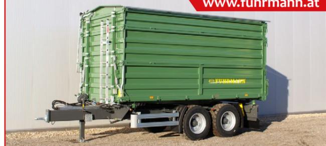
**FUHRMANN-Kipper** - Fahrzeugrahmen mit Zentralrohrdeichsel in bewährter LKW-Bauweise aus hochfesten Vierkantprofilen
